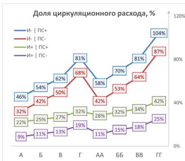
Рис. 3. Доля циркуляционного расхода в различных схемах системы ГВС
